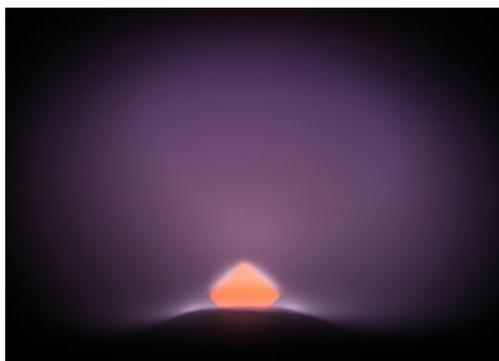
Синтез монокристаллического алмаза в СВЧ плазме.
